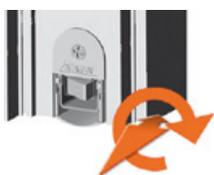
Einstellung durch seitlichen Anlaufkeil im Flügel möglich. (Rausziehen und nach rechts oder links drehen) Anpressdruck zum Boden verstellbar. Zu starkes Einstellen beeinträchtigt die Funktion der Türe (Ankleben der Dichtung bis zum Beschädigen der Dichtung ist die Folge). Achtung: der Automatische Türdichter unterliegt einem gewissen Verschleiß/Abrieb. Dadurch ist es erforderlich in gewissen Zeitabständen/Beanspruchungen das Dichtprofil zu tauschen.
