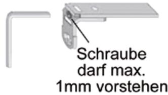
Einstellen der Hebesicherung; durch Drehen der Einstellschraube (Torx 15) die gewünschte Höhe wählen
